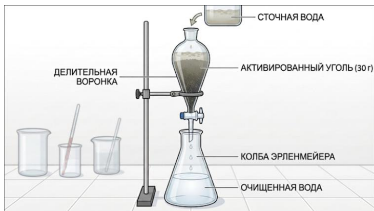
Рисунок 3 – Лабораторная установка для очистки сточных вод с использованием сорбента из рисовой соломы и шелухи
